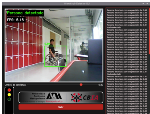
Fig. 12. Detección de silla de ruedas con umbral del 80 % a 4.5 metros de distancia.
